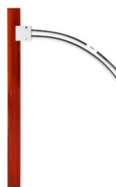
Figura 4.30: Senzorul STP01 pentru măsurarea temperaturii solului [159]
