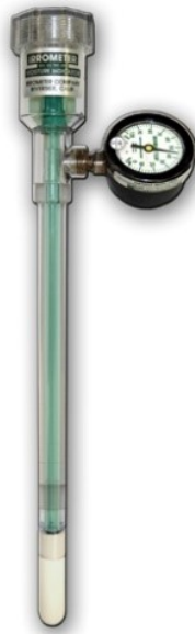
Figura 4.38: Tensiometru SR Irrrometer [173]
